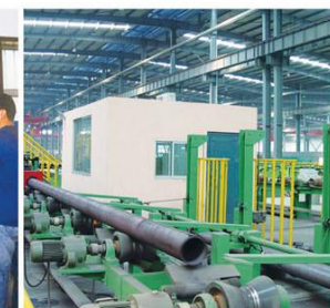
▲ 无损检测 涡流探伤 EDDY TEST
